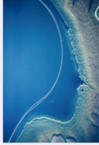
Ringkanalisation vor der Absehbung auf den Grund des Chiemsees. Foto: Zimmermann und AGU
