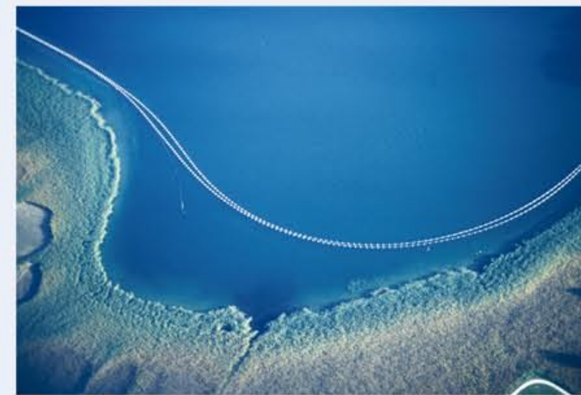
Ringkanalisation vor der Absenkung auf den Grund des Chiemsees. (Foto: Lohmann und AZV)
